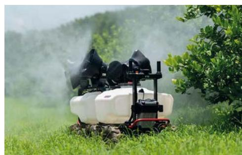
sono essere regolati per ottenere configurazioni multi-angolo o monolaterali al fine di adattare il rover alle diverse necessità. XAG R200 ha una larghezza di 80 cm e un peso di 130 kg. Il rover è in grado di rilevare automaticamente i pedoni davanti a sé: a 4 metri di distanza viene emesso un avviso, mentre a 2 metri la macchina si ferma.
