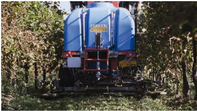
appositi attacchi rapidi e può essere applicato posteriormente alle irroratrici o alle macchine multifunzione trainate. In alternativa, tramite apposito attacco con terzo punto, la macchina può essere montata sui bracci del trattore, sia anteriori che posteriori. È dotato, su entrambi i lati, di un sistema brevettato con tastatori che, in caso di urto in svolta, traslano il dispositivo dalla parte opposta, verso interno, per poi riposizionarlo centralmente, in automatico, superato l'ostacolo.
