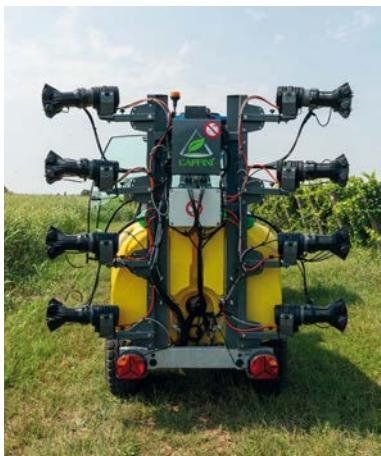
do sicurezza, manovrabilità a fine filare e riducendo usura e manutenzione. L'utilizzo di soffianti elettriche combinate a valvole PWM consente una regolazione istantanea della portata dell'aria e del liquido, creando una distribuzione a rateo variabile in tempo reale e in funzione della chioma rilevata, riducendo sprechi e deriva.
