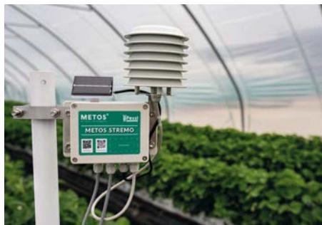
te di monitorare in tempo reale lo stress della pianta, misurando la traspirazione stomatica (tramite porometria), insieme a radiazione solare, temperatura dell'aria, deficit di pressione di vapore (VPD) e umidità relativa. Metos Stremo consente agli agricoltori di valutare lo stato delle piante, trasformando segnali fisiologici complessi in indicazioni chiare per una gestione più intelligente e mirata delle colture.
