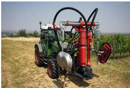
È dotata di due soffiatori con un totale di quattro ugelli, applicati a una testata. In base al risultato che si vuole ottenere, si possono attivare due o quattro ugelli indipendenti tra loro. Rispetto alla versione con un unico soffiatore (VITIpulse), la versione DUO garantisce una velocità di lavoro sensibilmente superiore. La lunghezza complessiva si riduce del 50% rispetto a una cimatrice montata anteriormente e con compressore posteriore.
