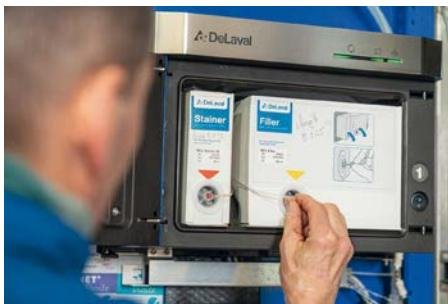
Il biosensore DeLaval Analisi Cellule del Latte (MCA) è un'innovazione che consente il conteggio automatico e in tempo reale delle cellule somatiche direttamente durante la mungitura. Integrato nei robot
