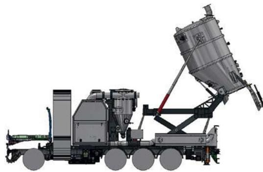
ne ad alta efficienza e un sistema costruttivo essenziale che minimizza usura e ferimi macchina, Cayman integra anche un braccio meccanico per la movimentazione delle attrezzature e uno scarico per ribaltamento fino a 3,5 m.
