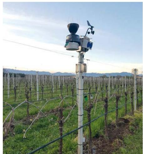
altri dati climatici per il calcolo del CWSI (Crop water stress index), integrato dal 2025 come nuovo elemento del DSS per migliorare ulteriormente la stima dello stress idrico. Il sistema è attualmente calibrato su vite e actinidia, ma può essere esteso ad altre colture.
