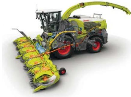
La regolazione indipendente e a variazione continua dei giri delle testate e della sezione di alimentazione consentono un flusso di prodotto ottimale.
