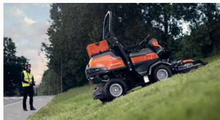
equipaggiata con una trazione integrale per garantire elevate performance anche in pendenza, inoltre presenta uno sterzo articolato che permette alle ruote posteriori di roteare sotto la macchina, assicurando un minimo raggio di non tagliato alla piena sterzata e facilitando le manovre anche in aree complesse. P 524XR EFI è compatibile con piatti di taglio ad alta capacità, fino a 137 cm di diametro. Il radiocomando consente all'operatore di gestire la macchina da una distanza di sicurezza.
