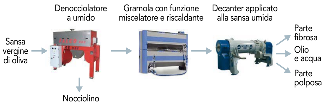
Figura 1 - Rappresentazione schematica dell'impianto di pretrattamento delle sanse vergini di oliva
