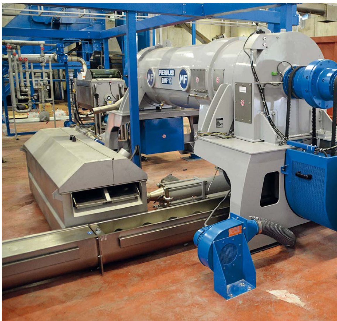
Foto 1 Centrifuga ad asse orizzontale per la separazione del pat  e della fibra di sansa
