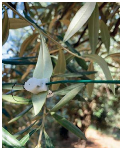
Foto 1 - Le sonde di turgore fogliare monitorano in continuo pressione e temperatura fogliari
