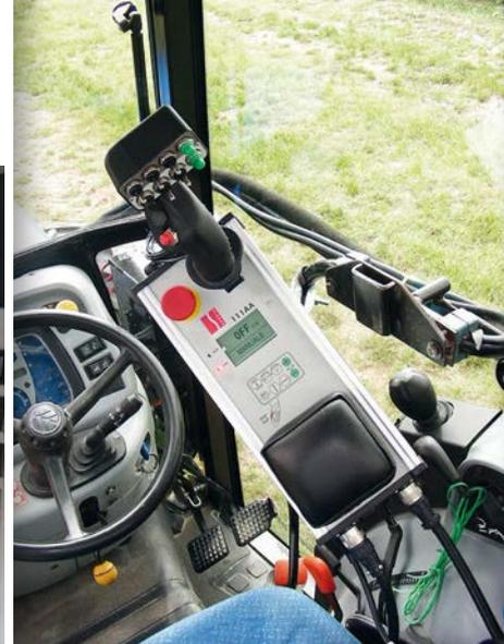
**10.** Sul joystick troviamo gli interruttori per gestire le varie funzioni tra cui la posizione della testata sfogliante, l'inversione dei rulli, il passaggio da manuale ad auto e i comandi di settaggio e programmazione della macchina con le indicazioni sul display delle regolazioni in corso
