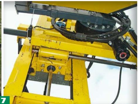
**6.** La testata defogliatrice è montata su una **ralla a rotazione idraulica** con motore dedicato in modo da ruotare il gruppo per operare sia a destra sia a sinistra del trattore. Due interruttori elettrici di fine corsa interrompono il movimento
