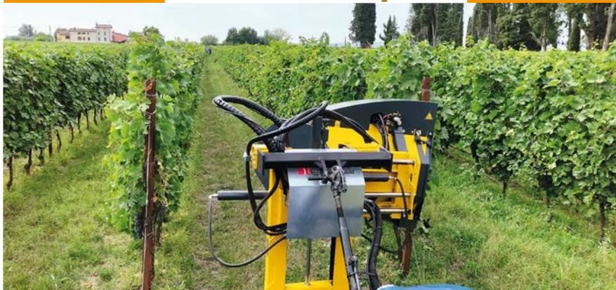
**Facili.** La prova è stata eseguita su appezzamento pianeggiante di forma regolare da 1,9 ha di superficie con viti di varietà Corvina. I filari presentavano una lunghezza media di 170 m con punte di 210 m. Il vitigno aveva sesto di impianto di 2,22 m di interfila x 0,81 m sulla fila. La defogliatrice era allestita su trattore New Holland T 4.95N con Supersteer e sollevatore anteriore. L'intervento è stato effettuato su grappoli prossimi alla raccolta e su un solo lato di ogni filare.
