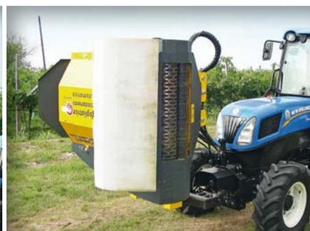
Il modello da noi visionato era dotato di **sistema idraulico di reversione della testata** in modo da poter intervenire su entrambi i lati dello stesso filare
