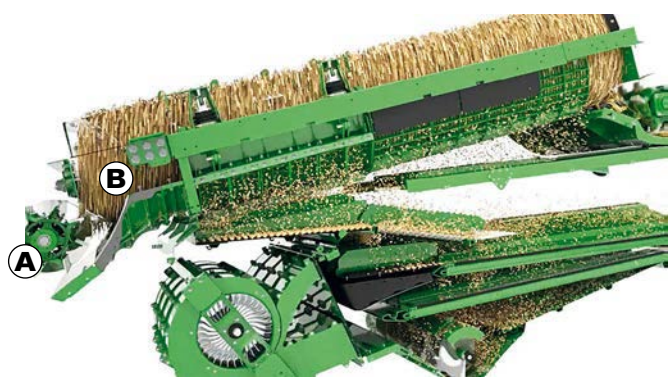
La raffigurazione della soluzione a doppio rotore di John Deere presente nella X9: l'acceleratore (A), i due rotori (B) lunghi 3.510 mm da 610 mm di diametro
