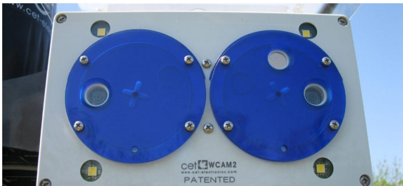
WCAM2 è una particolare telecamera utilizzata per il controllo dello sviluppo vegetativo del vigneto. Installata permanentemente di fronte ad alcune piante di un filare, acquisisce foto giornaliere che vengono poi elaborate da un software, riconoscendo automaticamente la vegetazione e ricostruendone la struttura 3D, grazie alla particolare tecnologia di
