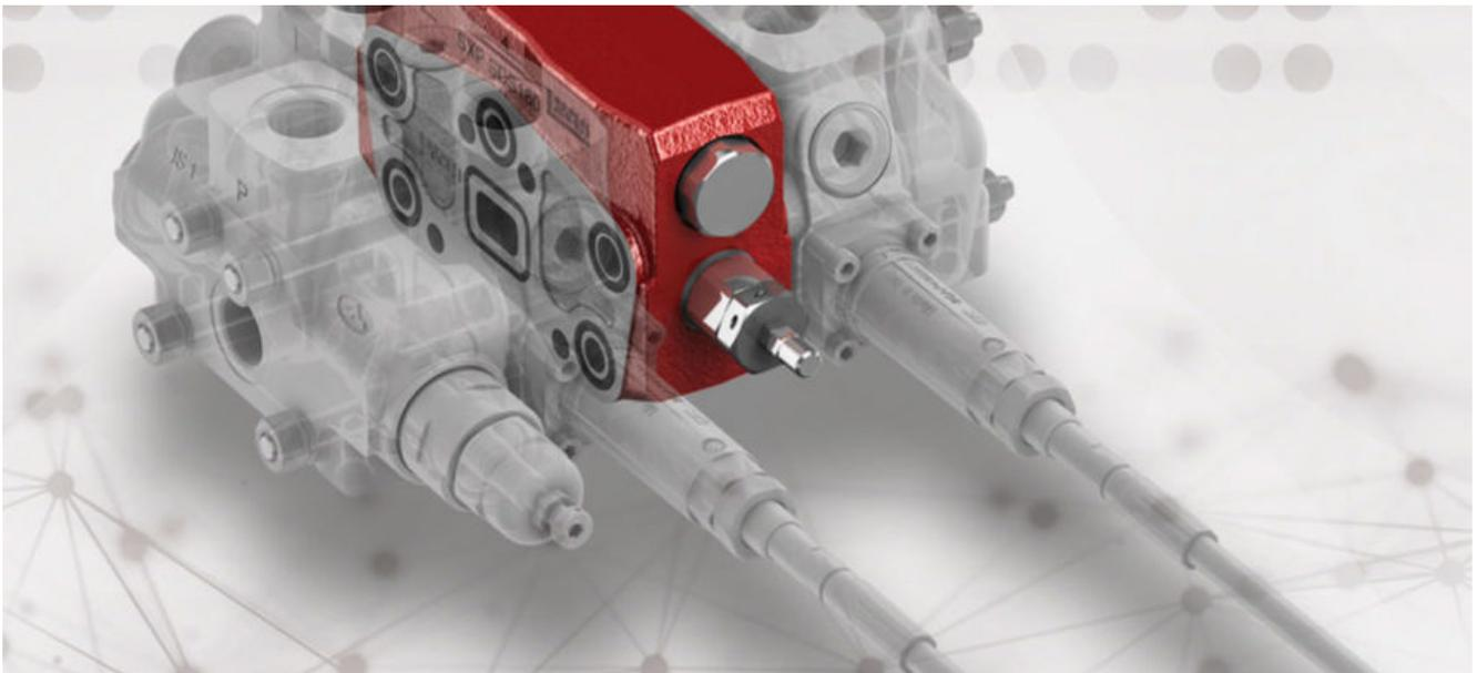
Valvola distributrice per caricatori frontali che gestisce la portata d'olio in due diverse modalità, serie e parallelo, finora adottate solo separatamente a seconda della scelta progettuale di ogni caricatore. La soluzione Walvoil consente di massimizzare la velocità delle movimentazioni di sollevamento e brandeggio ed evita fenomeni indesiderati di arresto o di riduzioni di velocità.
