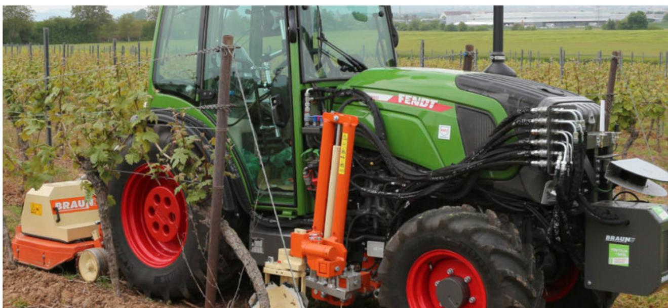
VPA (Vineyard Pilot Assistant) è un sistema indipendente che in tempo reale posiziona e regola in modo automatico l'attrezzatura montata sul trattore in posizione ventrale o posteriore.
