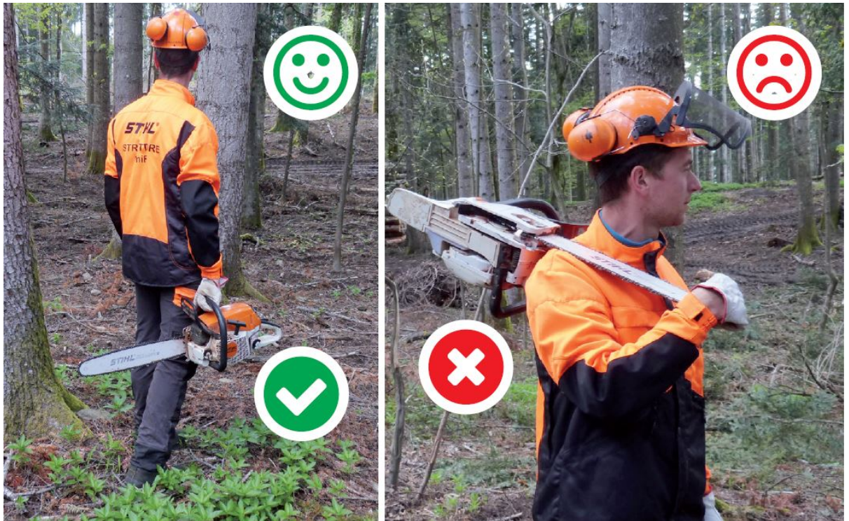
La motosega va trasportata in modo corretto e non «a spalla»
