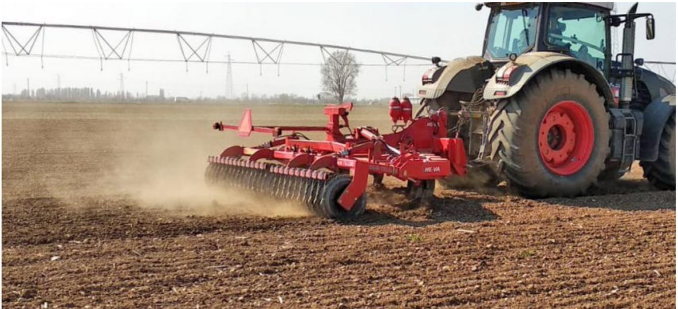
La necessità di eseguire lavorazioni del terreno in modo più efficiente sta favorendo la **diffusione dei decompattatori**, oltre che in agricoltura conservativa, anche **in sostituzione dell'aratura e della dissodatura**, avvicinando la tecnica agronomica a un approccio di **minore disturbo del suolo**. L'esperienza di impiego di questa attrezzatura resta ancora limitata, nonostante i modelli siano presenti sul mercato da diversi decenni.
