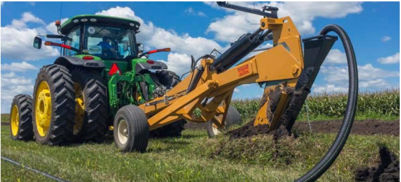
Il posadreni Soil-Max Gold Digger è un attrezzo che permette un'installazione precisa dei tubi di drenaggio grazie a un sistema di guida GNSS.
