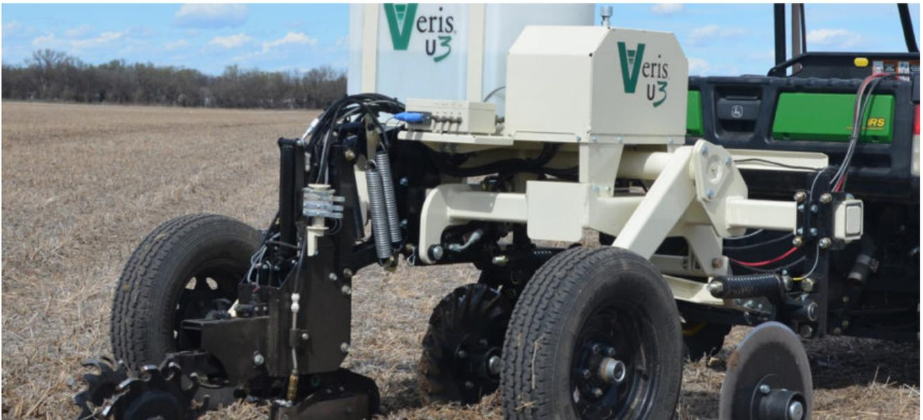
Veris U3 è un sensore per la mappatura delle caratteristiche del terreno.
