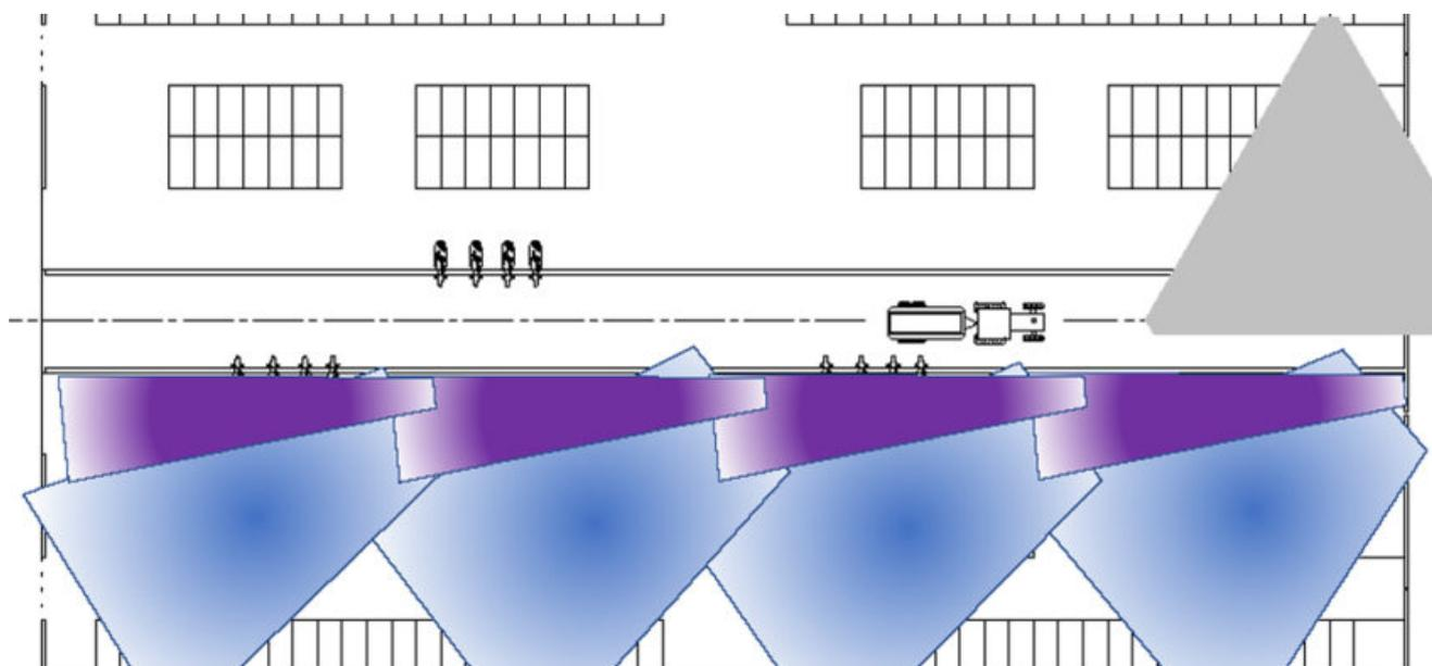
Ro-Tor è un dispositivo di ventilazione per ambienti, in particolare per stalle di bovini, che consente di ridurre il numero totale di dispositivi necessari grazie al suo movimento di rotazione.
