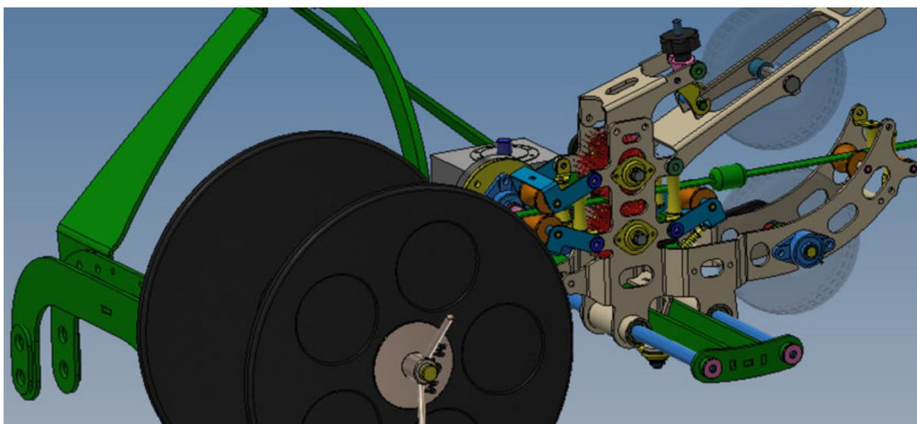
Recycle è un nuovo avvolgitore che permette di raccogliere e ribobinare l'ala gocciolante al fine di un riutilizzo pluriennale. In questo modo l'utilizzatore ottiene un risparmio economico ma soprattutto ecologico, in quanto si riduce la produzione di materiali plastici. L'azionamento dell'avvolgitore è idraulico e la bobinatura automatica è eseguita tramite un cilindro idraulico.
