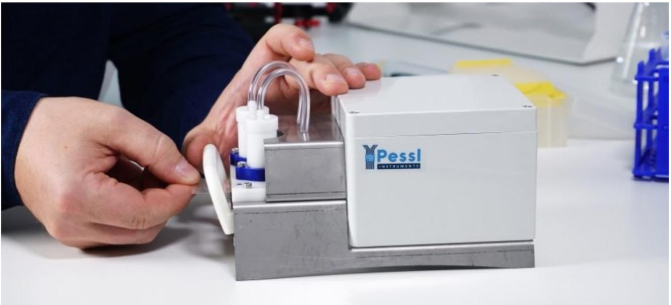
**Mobilab** è un analizzatore innovativo per substrati e componenti vegetali. Permette un facile rilievo di nitrati e  $\text{NH}_4$  in diverse matrici (suolo, foglie, acqua).
