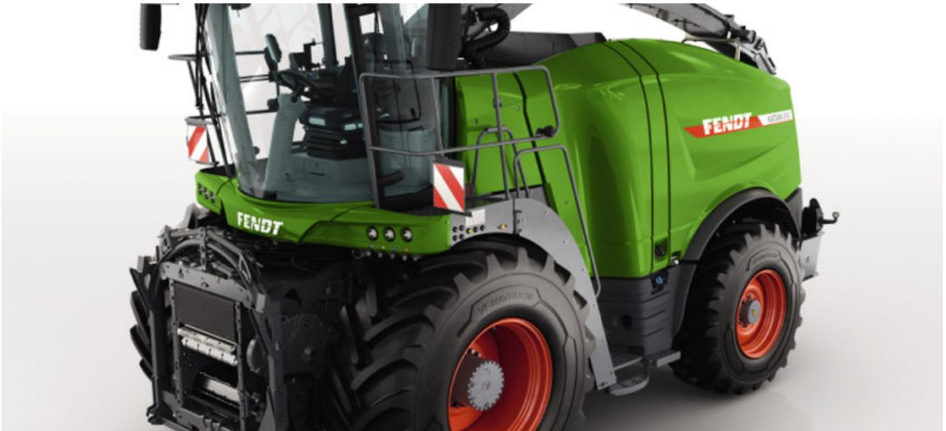
Katana 650 è una nuova trincia con motore MTU da 650 CV con 6 cilindri emisionato stage V. La macchina ha incrementato la performance e migliorato anche l'efficienza nei consumi, stimata maggiore del 12%. Il tutto grazie ad aggiornamenti effettuati nel flusso di prodotto, dall'alimentazione al tubo di scarico.
