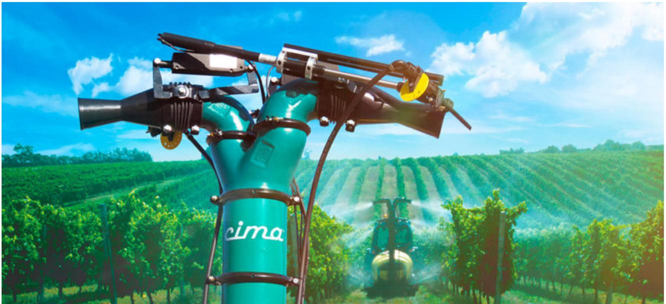
Diffusore per macchina irroratrice pneumatica che può venire posizionato in un punto più esterno rispetto all'erogatore dell'aria. In questo modo, la dimensione delle gocce aumenta e la deriva diminuisce.
