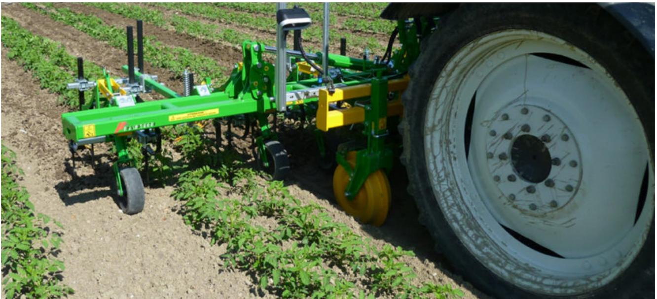
GreenCam è una videocamera applicabile sulla macchina operatrice che consente di rilevare e inviare le immagini sia a un monitor in cabina sia al sistema di controllo. Il sistema di traslazione automatico a controllo ottico consente di riconoscere la coltura dalle erbe infestanti, permette di lavorare molto vicino alla pianta coltivata guidando l'attrezzatura agganciata, indipendentemente
