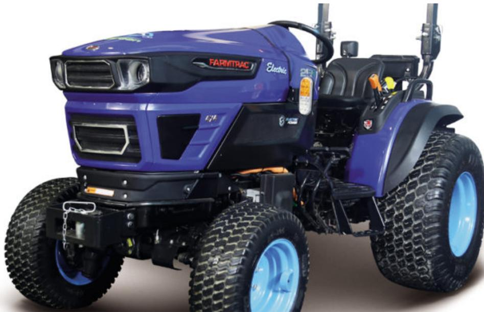
FT25-G di Farmtrac è un trattore elettrico compatto realizzato per pratiche agricole sostenibili garantendo un livello di rumorosità ed emissioni ridotte al minimo. La macchina è alimentata da motore a induzione da 15 kW e da una batteria agli ioni di litio ricaricabile con sorgente domestica.
