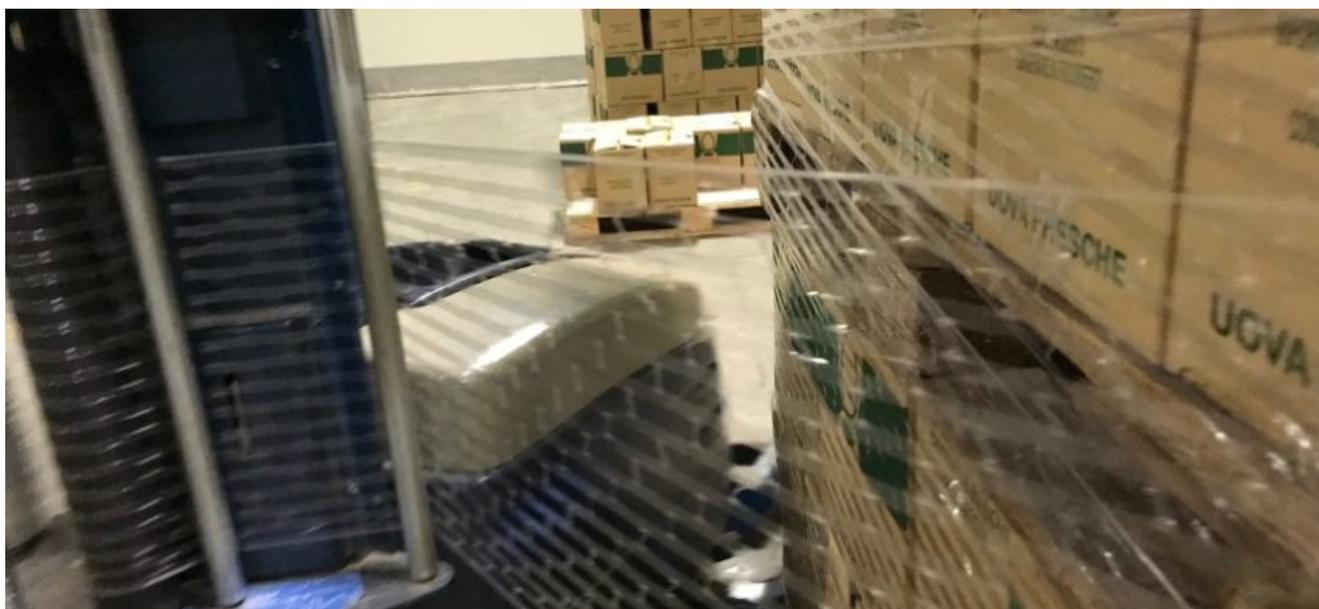
**Fiber film** è un film realizzato con inserti e rinforzi, capace grazie alle sue caratteristiche di resistenza e elasticità di superare i limiti dei comuni materiali su tutte le applicazioni di avvolgimento dei bancali, così da limitare le deformazioni e i danni al prodotto pur mantenendo un carico strutturale superiore alla normale destinazione.
