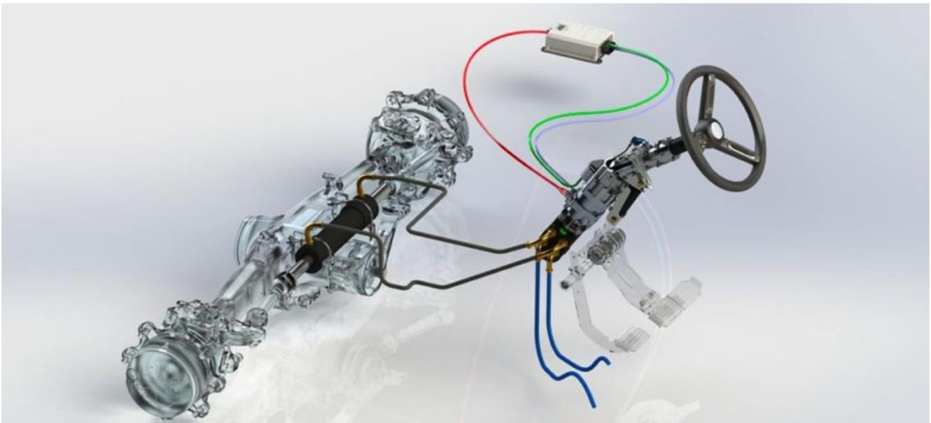
Colonna di sterzo con motore elettrico coassiale; il motore ha l'obiettivo di controllare la coppia sullo sterzo per migliorare il feeling di guida, ridurre l'affaticamento e automatizzare alcune operazioni. È una soluzione pensata in modo particolare per l'utilizzo su strada.
