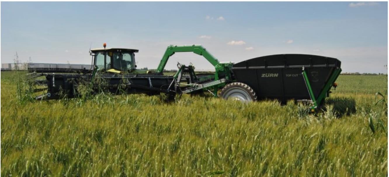
Il costruttore tedesco **Zürn Harvesting** ha realizzato un'operatrice per il **controllo meccanico delle infestanti** che lavora eseguendo il taglio e la raccolta delle infiorescenze. Una soluzione che consente di entrare in campo anche nelle fasi tardive delle colture e contemporaneamente **ridurre la presenza dei semi delle malerbe a terra.**
