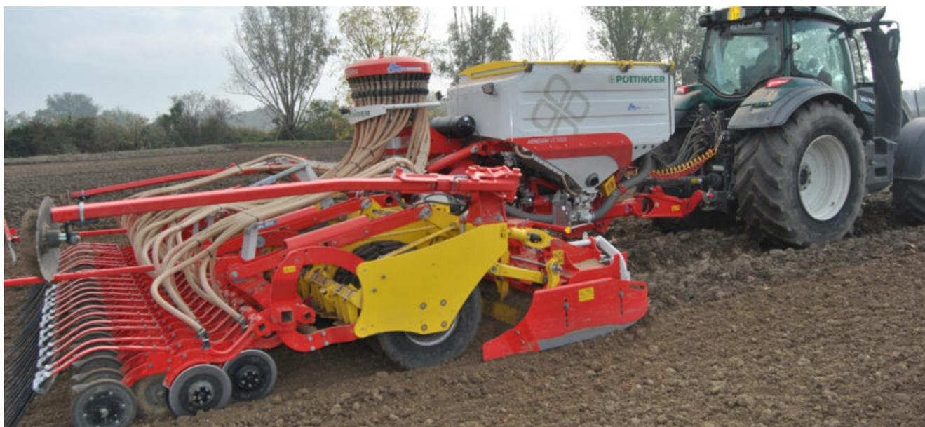
Abbiamo provato la **seminatrice semiportata pneumatica Aerosem** del costruttore austriaco **Pöttinger** nella versione da 5 metri a 40 file (modello VT5000 DD), **combinata a un erpice rotante**. Introdotto nel mercato a febbraio del 2021, l'operatrice si rivolge ad aziende con livello professionale elevato, per la semina a righe di diverse colture (frumento, orzo, segale, avena, erba medica, pisello, farro, soia in 2° raccolto, colza) su superfici di dimensioni medio-grandi.
