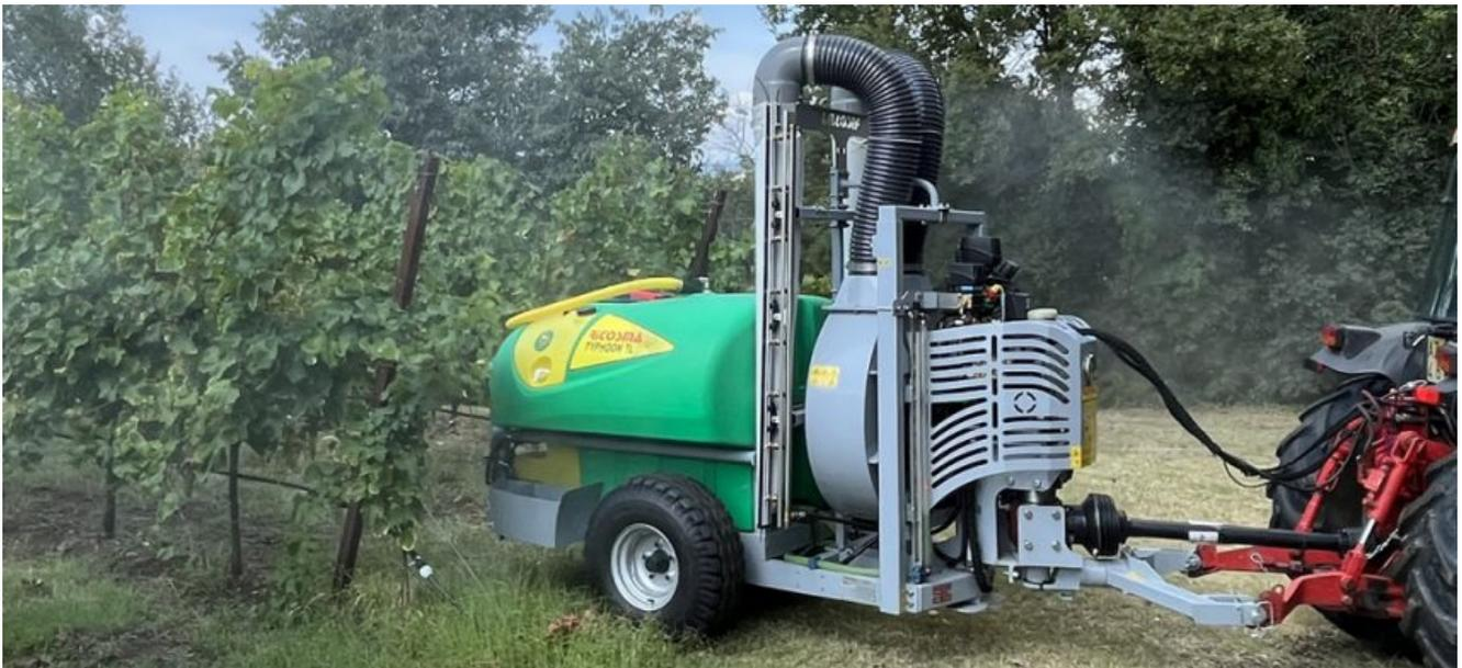
Il **nebulizzatore trainato** del costruttore vicentino **Ricosma** si distingue per una serie di particolarità costruttive quali lo snodo con scatola di trasmissione doppia e il sistema di diffusione della soluzione fitosanitaria attraverso la **manica ad aria**, soluzione questa già largamente impiegata sulle barre irroratrici da pieno campo.
