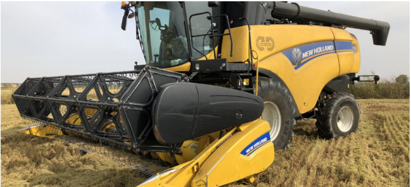
**New Holland** punta a nuovi standard di qualità e produttività **sotto la soglia dei 400 CV** con la nuova **Crossover Harvesting (CH)**. Una mietitrebbia ibrida scaturita dall'incrocio di due «linee pure» di casa NH: la serie flagship CR e le midrange CX. Il risultato è una semovente con sistema trebbiante che sfrutta la **sinergia tra il battitore delle convenzionali e il doppio rotore delle assiali**.
