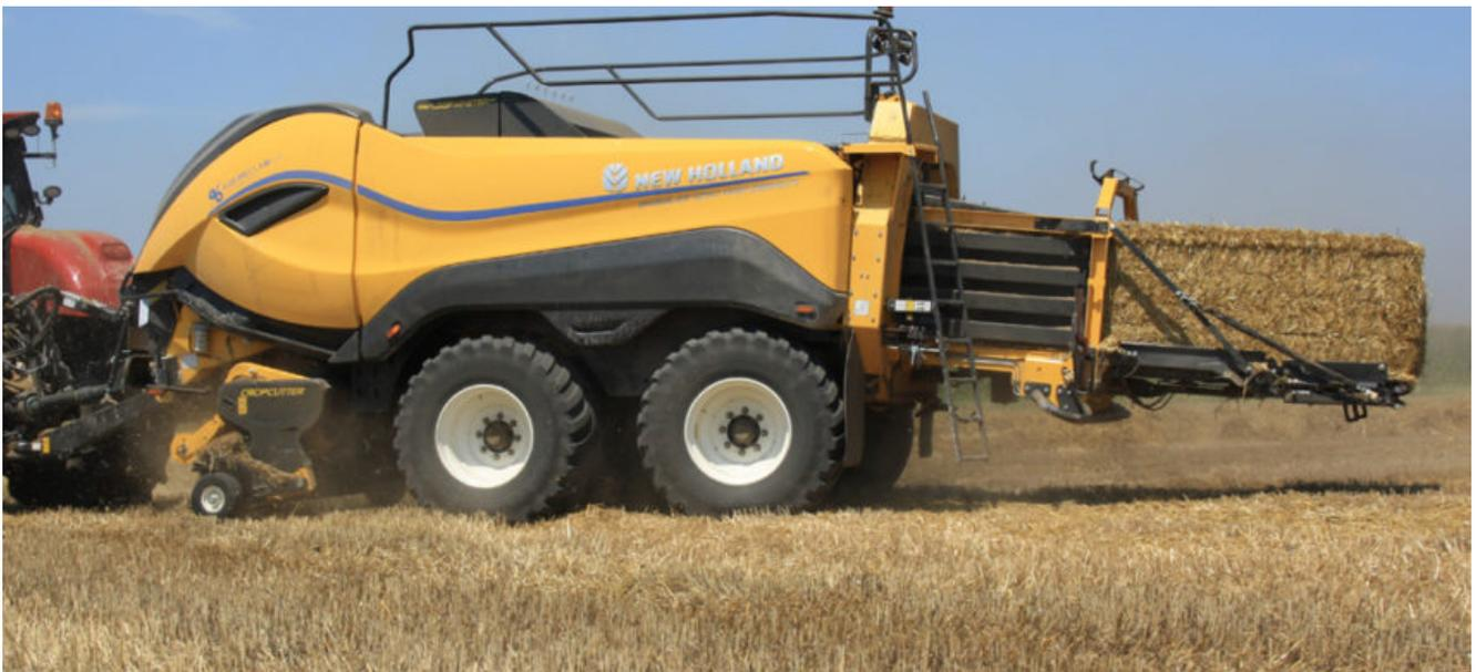
Nella ristretta cerchia dei costruttori di presse quadre ad alta densità, è apparsa quest'anno la **nuova BigBaler High Density di New Holland**. Un'operatrice completamente rivista rispetto ai modelli Plus, sia nella struttura sia nella catena cinematica, al fine di garantire livelli di densità superiori a  $175 \text{ kg/m}^3$  di prodotto e balloni che possono superare i 500 kg di peso.
