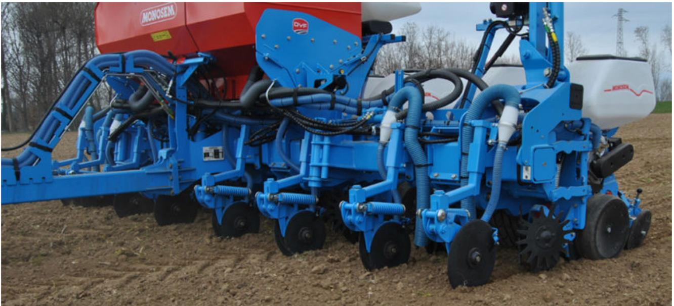
Per le grandi superfici e per elevate esigenze di precisione il **costruttore francese Monosem** propone la seminatrice pneumatica **monogerme con assolcatore a doppio disco**. Abbiamo provato la versione con 8 elementi di semina (75 cm di interfila) completa di tramoggia per concime e microgranulatore, con gestione interamente elettrica.
