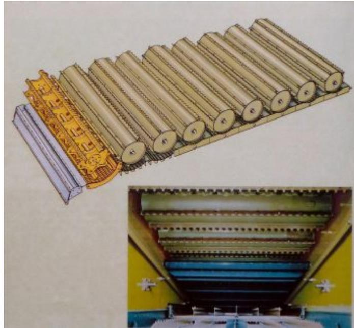
Dietro al battitore le mietitrebbie della serie **Claas CS** erano dotate di **8 cilindri** atti a potenziare la separazione
