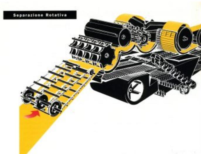
**New Holland** sulla sua serie **TF** posizionò dietro al battitore un **largo cilindro** che, aprendo il flusso in due, **aumentava la capacità di separazione**
