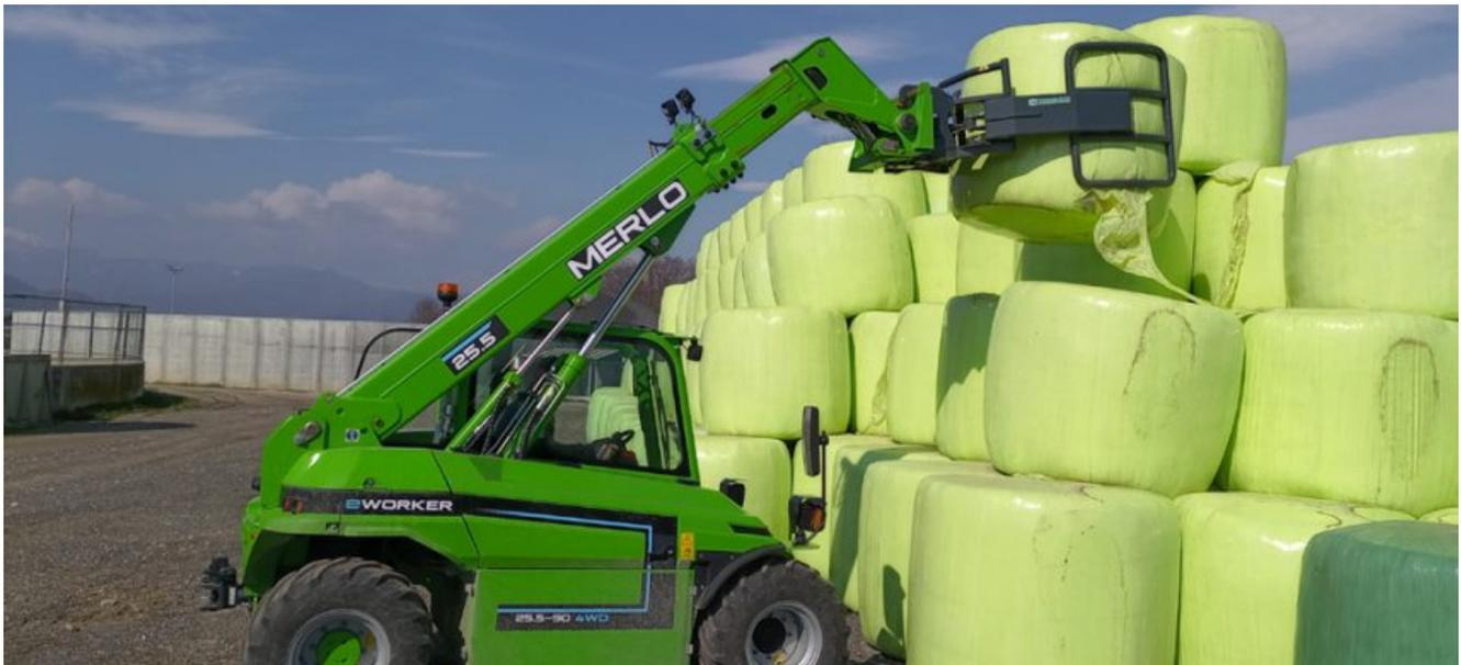
Dopo il lancio nel 2014 del telescopico ibrido, il costruttore cuneese approda nel mondo dell'elettrico con il **telescopico compatto e-WORKER** da 2.500 kg di capacità massima di sollevamento e un'altezza di carico di **4,8 m** per una massa complessiva, senza attrezzi, di 4.950 kg. Recentemente abbiamo visionato la versione a 4 ruote motrici nelle tipiche operazioni di movimentazione, carico e scarico.
