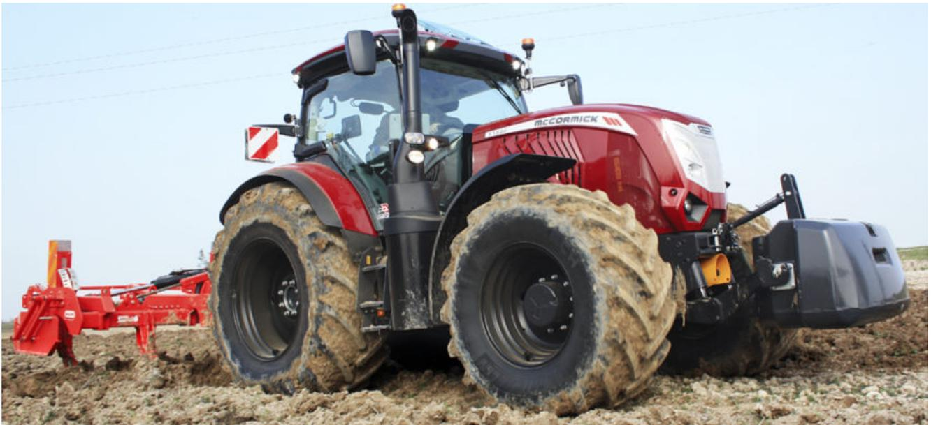
**McCormick** si inserisce nel conteso segmento dei trattori da 200 CV a variazione continua con la **nuova serie X7.6 VT-Drive**: tre modelli caratterizzati dal collaudato e brillante motore **Fpt a 6 cilindri, 6,7 L**, da una ricca dotazione tecnologica in chiave 4.0, da un design aggressivo richiamano le iconiche muscle car americane e da potenze fino a 240 CV in Power Plus. degli X7.6
