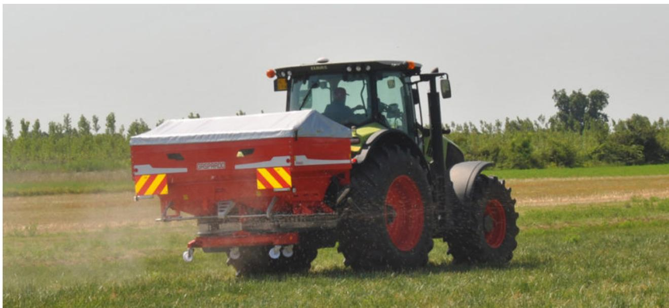
Lo **spandiconcime Primo 332 versione EW Isotronic di Maschio-Gaspardo** è di tipo portato e conta di un robusto telaio portante e di sistema di **distribuzione centrifuga del concime a doppio disco** (peso complessivo a vuoto 650 kg; larghezza di lavoro 12-36 m).
