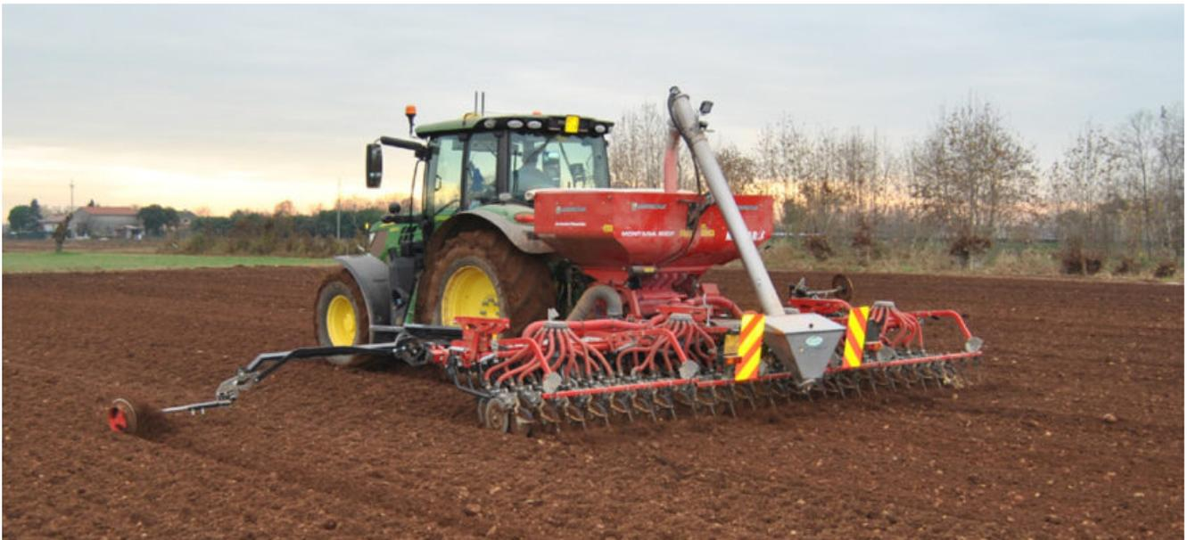
In operazioni di semina del grano abbiamo provato la **seminatrice pneumatica a righe** del costruttore **Mascar** con sede a Grumolo delle Abbadesse (Vicenza). L'oggetto della prova è stata la versione da **6 metri di larghezza di lavoro** della serie **Montana**, con 48 file gestite da 4 dosatori elettrici e 4 ripartitori volumetrici, trasporto pneumatico di seme e concime per un peso complessivo pari a **1.790 kg**.
