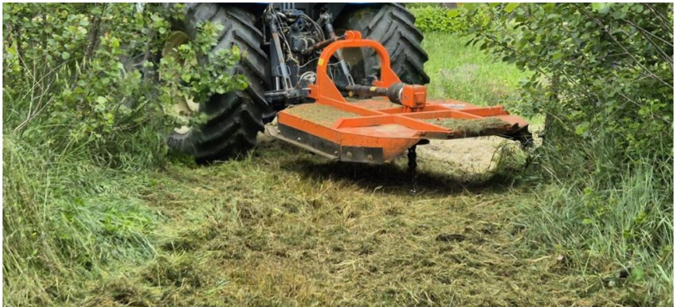
Attraverso una serie di rilievi strumentali, sono state valutate le prestazioni operative della trincia a catena del costruttore leccese Pellerano **modello TN190** su substrato erboso e su polloni di pioppo provenienti da impianti Medium Rotation Forestry (MRF). Attraverso l'applicazione di **due differenti tipologie di catene (8 e 13 mm)**, si è determinato l'assorbimento di potenza, il consumo di carburante e l'effetto finale sulla vegetazione.
