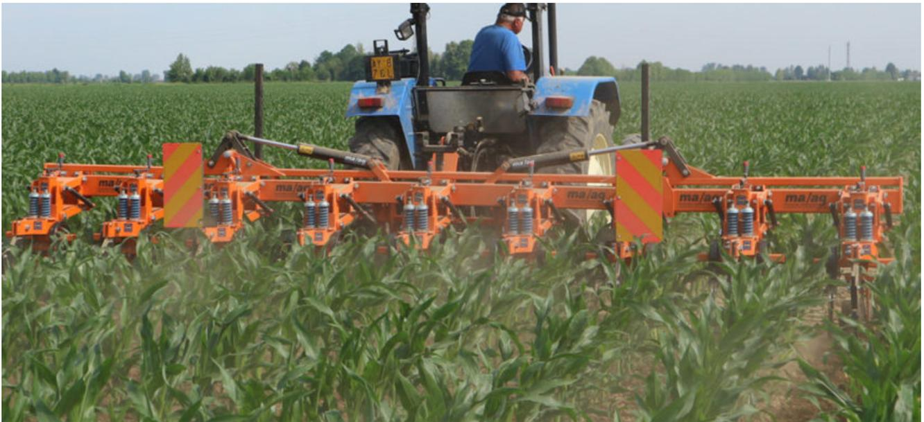
Per terreni lavorati o su sodo, il costruttore **MA/AG** offre la serie di **sarchiatrici pesanti SP** per un'azione energica di rimescolamento anche su terreni compattati o tenaci e con presenza di piante alte fino a 80 cm.
