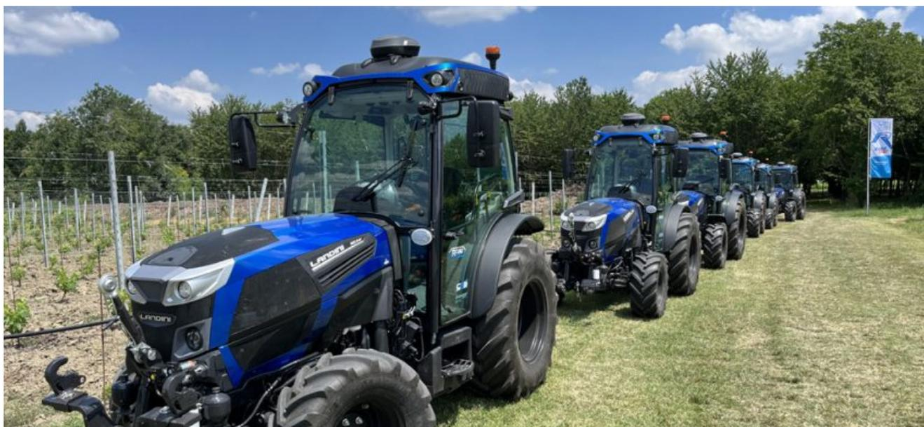
Con l'evento **RoboTour** il costruttore italiano **Argo Tractors** mette in campo i primi modelli della serie di trattori specializzati **Landini Rex4** con trasmissione robotizzata **RoboShift**.
