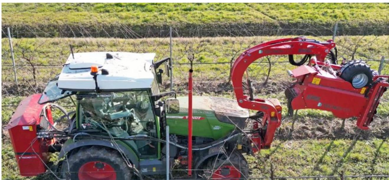
La **meccanizzazione in vigneto** punta ad agevolare gli interventi che, se fatti manualmente, richiedono un forte dispendio di energia oltre che di tempo. L'operazione che richiede maggior sforzo e impegno fisico da parte degli operatori è sicuramente la **stralciatura**, ovvero la rimozione dai fili di sostegno dei tralci che non hanno più alcuna utilità per la nuova stagione produttiva.
