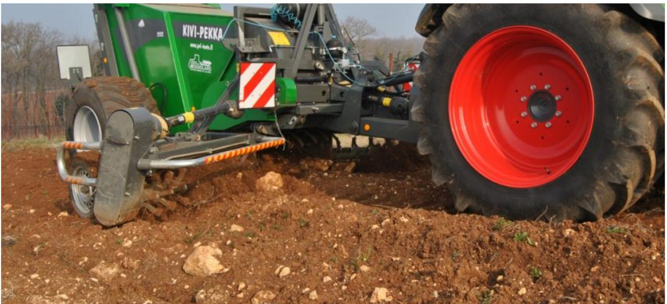
Il costruttore finlandese Pel-Tuote propone la gamma di operatrici Kivi-Pekka per la raccolta di sassi e ciotoli: un'operazione quanto mai necessaria specialmente in condizioni di eccessiva presenza di scheletro. In provincia di Vicenza abbiamo visionato il modello ad assale singolo con **fronte di lavoro di 5 m e cassone da 2 m<sup>3</sup> di capacità**.
