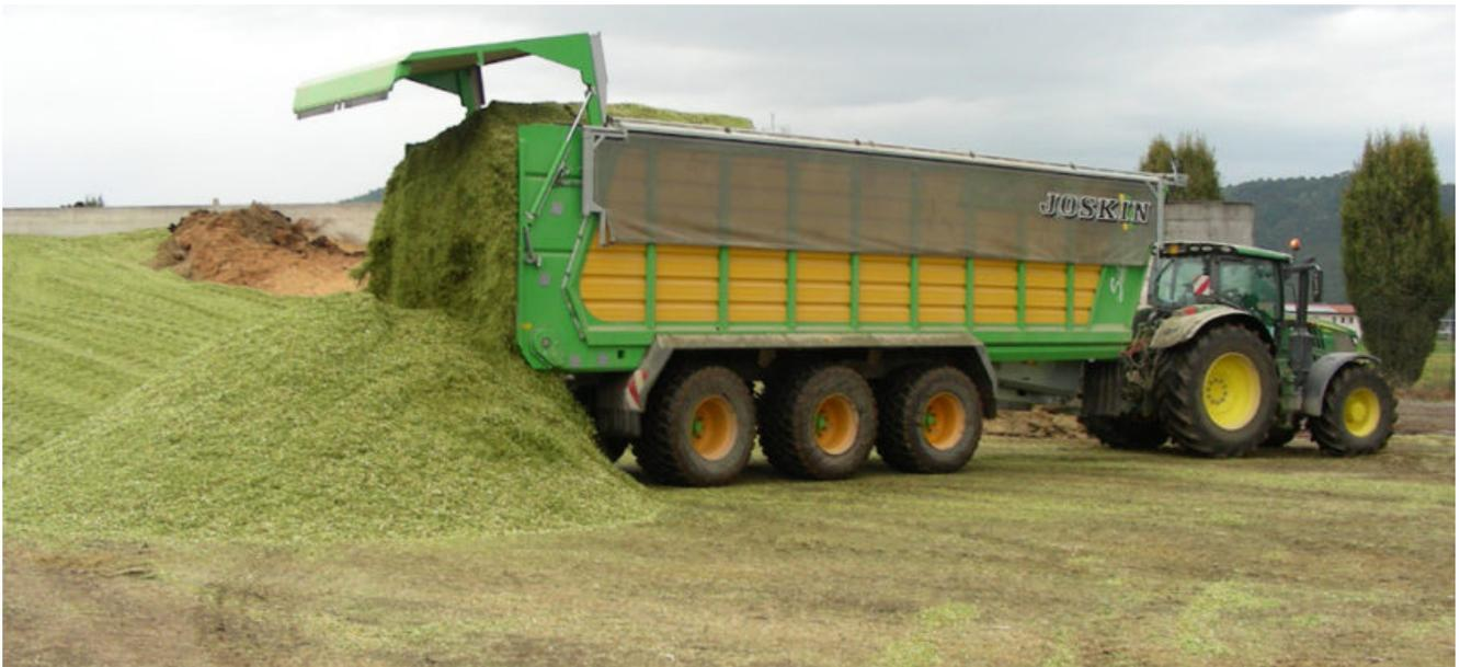
Il dumper del costruttore belga **Joskin** rappresenta un'alternativa ai tradizionali rimorchi ribaltabili. Nel periodo di raccolta del trinciato abbiamo esaminato il **modello a tre assi da 59 m<sup>3</sup> di capacità e sistema di scarico orizzontale a doppie catenarie**. Una soluzione che ha tra i punti di forza la stabilità generale del cantiere in fase di scarico e la riduzione dei tempi morti in trincea.
