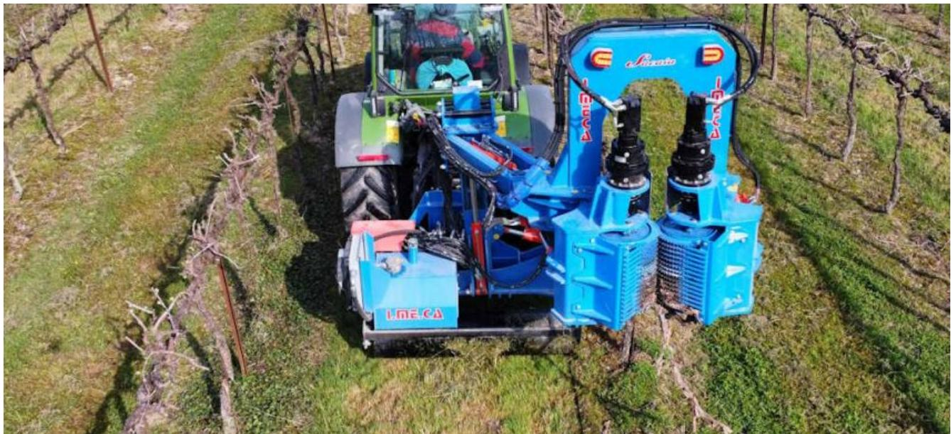
Tra le soluzioni volte a ridurre tempi e costi necessari alla rimozione del vecchio impianto di vigneto, si è visionata la scordonatrice portata TTC del costruttore pordenonese I.ME.CA, una soluzione che permette di trinciare i cordoni ancora avviluppati al filo portante dei filari limitando drasticamente l'intervento manuale.
