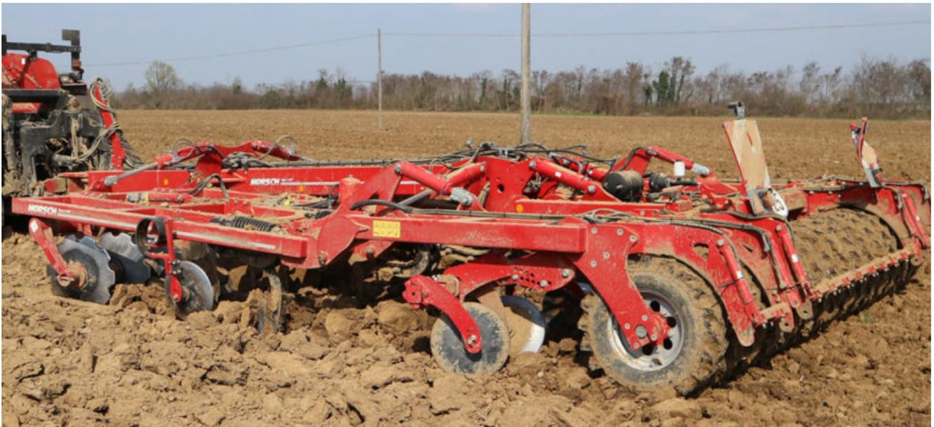
Le **operatrici per la minima lavorazione** del terreno sono attrezzature offerte in molte varianti di allestimento, caratterizzate da appositi telai regolabili sui quali vengono applicate diverse combinazioni di utensili quali ancore, dischi e rulli, in numero, geometria e disposizioni variabile in funzione della tipologia di terreno e dell'azione desiderata.
