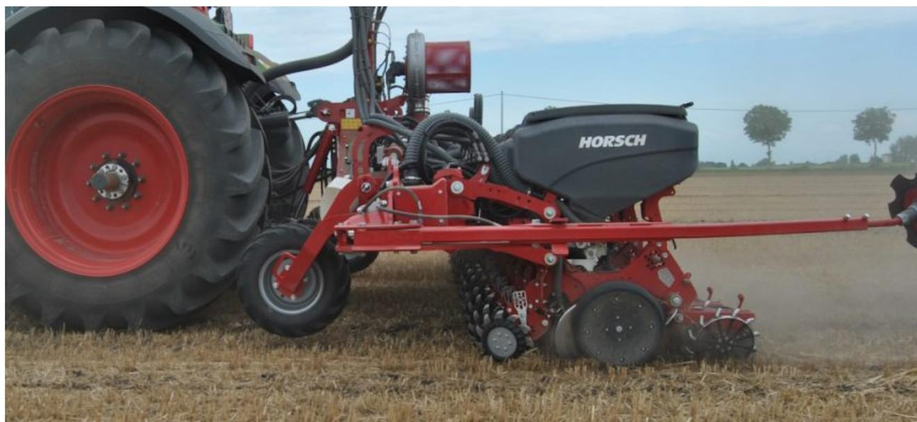
In due differenti condizioni operative, con presenza di stoppie di cereale e su terreno erpicato in superficie, si è provata la seminatrice a 12 file del costruttore tedesco Horsch nel modello Maestro RX12.
