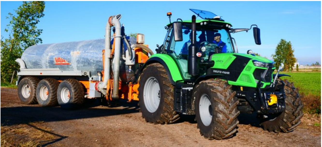
I principali costruttori di macchine agricole hanno recentemente esteso la loro gamma di trattori introducendo **modelli di media potenza**, indicativamente tra i 130 e i 180 CV di potenza (95-132 kW), caratterizzati da **compattezza, flessibilità d'impiego ed elevate specifiche tecniche**.
