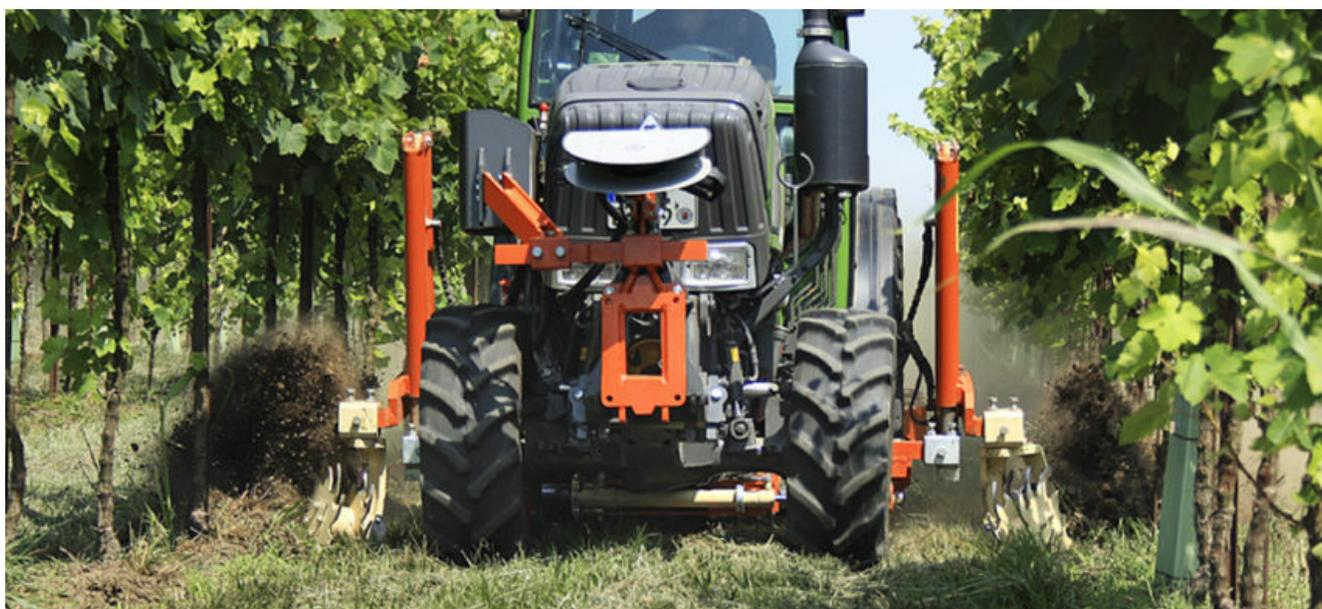
Una **gestione efficace, efficiente e sostenibile del sottofila** è tra le recenti sfide della moderna viticoltura. Il costruttore tedesco **Braun** propone **Vineyard Pilot Assistant (VPA)**, una soluzione a **controllo ottico** per identificare in tempo reale la posizione dei ceppi adeguando in automatico l'elemento scalzatore con vantaggi in termini di qualità e tempi di lavorazione, oltre al comfort per l'operatore.
