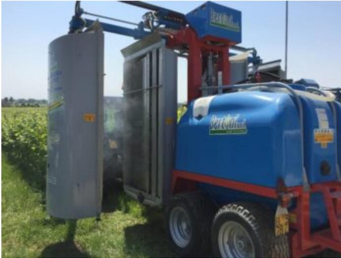
L'esemplare da noi provato possiede una massa complessiva a vuoto di 2.200 kg che a pieno carico, con cisterna da 1.500 litri, arriva a 4.030 kg; mentre sull'occhiello del trattore l'atomizzatore grava per un peso di 600 kg.
