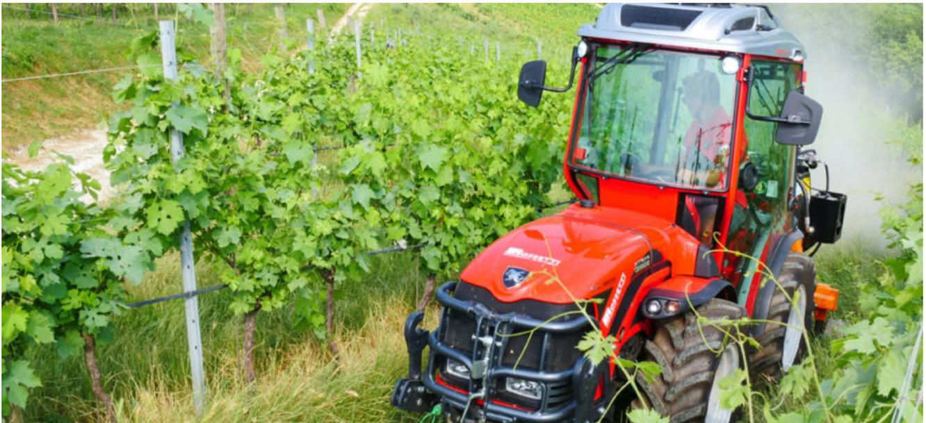
Agile e compatto, il **nuovo isodiametrico di Antonio Carraro** è pensato per svolgere lavorazioni leggere con attrezzature ad alta richiesta idraulica. Tra gli stretti e pendenti filari di vite delle colline della Valpolicella, abbiamo provato la versione articolata e snodata con guida reversibile da 52 CV di potenza e **cabina RedCab a 4 montanti**.
