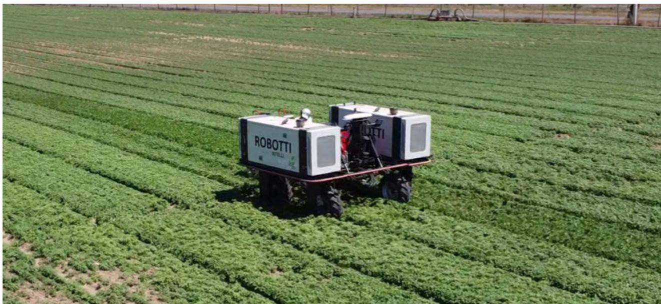
Realizzato dalla **danese Agrointelli**, il **Robotti** è tra i primi robot agricoli disponibili in Italia per lavorazioni in pieno campo. Durante la sarchiatura del basilico abbiamo visto al lavoro il modello maggiore 150 D azionato da due motori Kubota da 72 CV e dotato di attacco a 3 punti e pdp.
