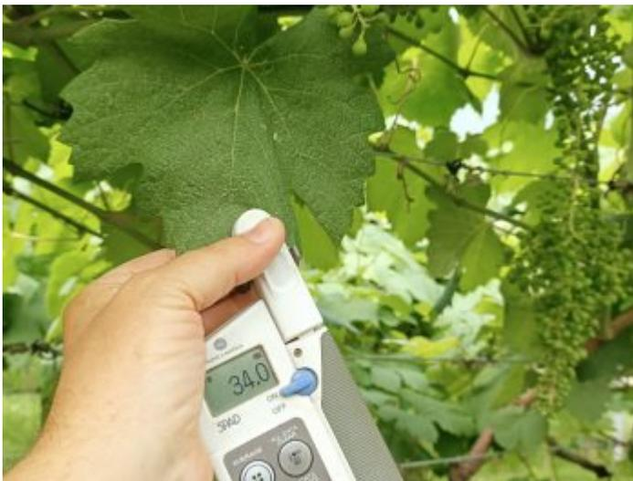
Rilievo su foglia con SPAD, strumento che stima il colore delle foglie e indirettamente lo stato nutrizionale azotato.
