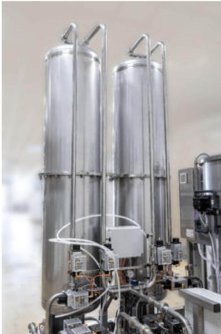
Gli impianti di trattamento cationico di maggiori dimensioni sono costituiti da due colonne separate. Quando in una colonna viene trattato il vino a cui togliere il potassio nell'altra si effettua la rigenerazione acida delle resine.
