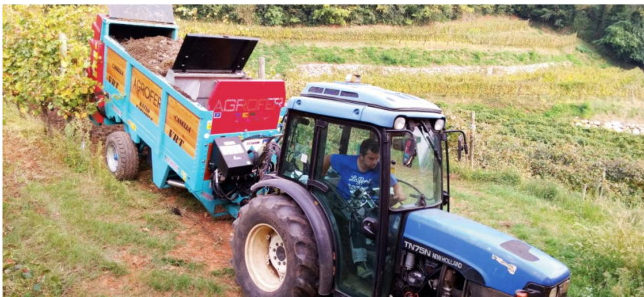
La **concimazione organica** migliora struttura e fertilità dei suoli, realizzarla mediante macchine a rateo variabile è l'obiettivo del progetto Vitisom, che ha portato alla realizzazione di prototipi e alla loro valutazione in contesti viticoli differenti.
