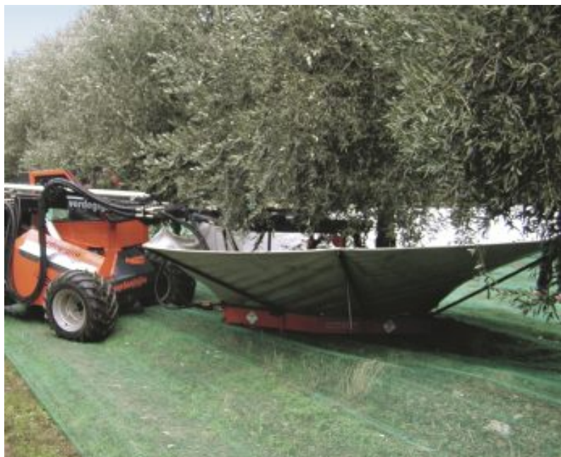
Macchina scuotitrice intercettatrice a ombrello (scenario B)
